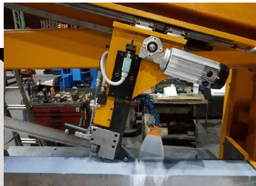
Il pattino mobile si sposta seguendo il profilo del pezzo The sliding blade-guide moves according to the profile of the piece
