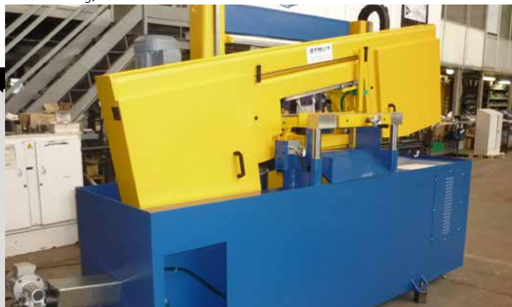
Arco inclinato di 10° per taglio di barre multiple 10° tilted bow for multiple bars cutting
